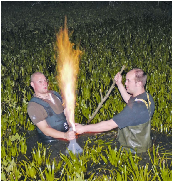
ABB. 3 Das Volta-Experiment. Man taucht einen großen Trichter umgekehrt ins Wasser, verschließt ihn mit dem Daumen oder einem Stopfen, rührt mit einem Stock den Schlamm auf und sammelt im Trichter die aufsteigenden Blasen des Sumpfgases. Das lässt sich anzünden, wenn man den Daumen/Stopfen abzieht. Foto: Andreas Brune.
