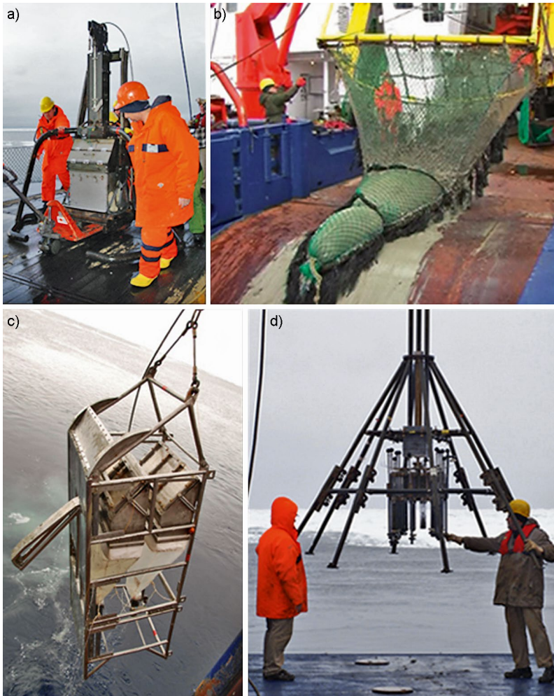
ABB. 4 Probenahmegeräte im Einsatz auf der POLARSTERN. a) Großkastengreifer und b) Agassiz-Trawl. c) Epibenthoschlitten und d) Multicorer. Fotos: Gritta Veit-Köhler (a, d), Nils Brenke (b), Angelika Brandt (c).
