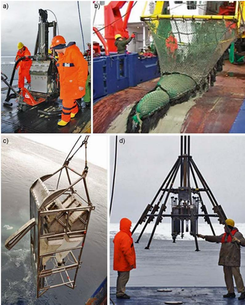
**ABB. 4** Probenahmegeräte im Einsatz auf der POLARSTERN. a) Großkastengreifer und b) Agassiz-Trawl. c) Epibenthoschlitten und d) Multicorer. Fotos: Gritta Veit-Köhler (a, d), Nils Brenke (b), Angelika Brandt (c).
