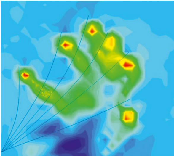
ABB. 15 Verteilung der Wirbelstärke hinter der Schwungfederkaskade eines Storches nach Windkanaluntersuchungen von [15]. Die Position der einzelnen Schwungfedern ist markiert. Von jeder Schwungfederspitze geht ein kleiner Randwirbel ab. Die Teilwirbel vereinigen sich nach zwei bis drei Spannweiten stromab wieder zu einem kompakten Wirbel. Foto: Institut für Aerodynamik, TU München.
