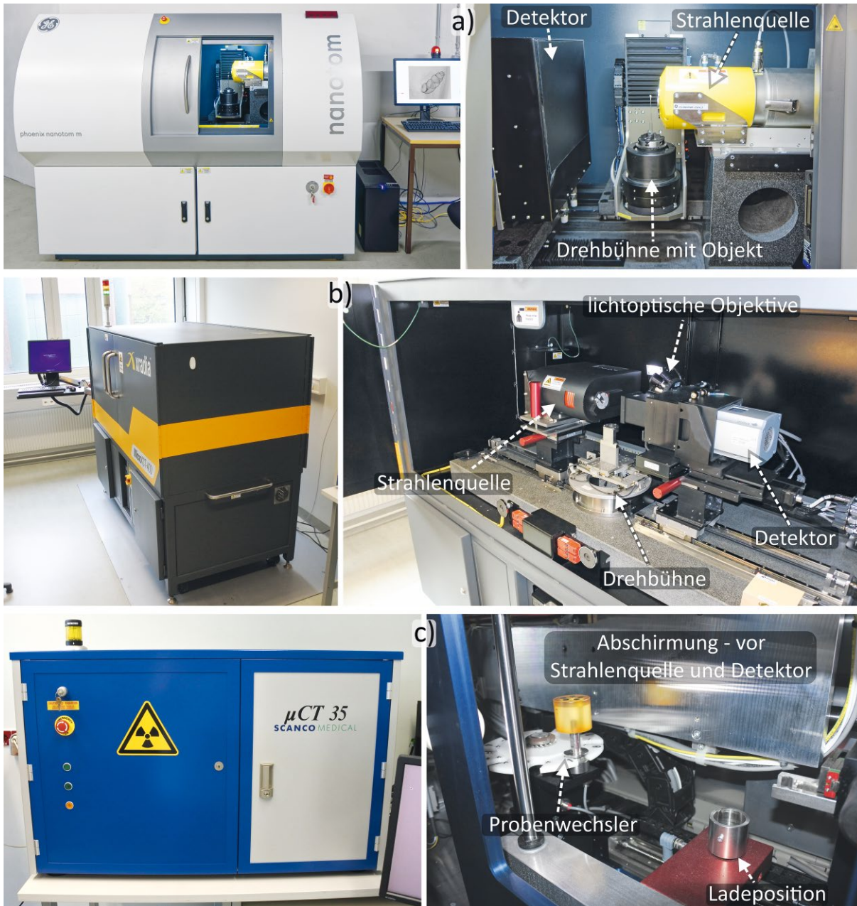
ABB. 5 Verschiedene MikroCT-Geräte und deren Innenraum. a) Nanotom m (Phoenix), GE Sensing & Inspection, mit offener Röntgenröhre und einem Flat Panel Detektor. b) MicroXCT-400 (XRadia), Carl Zeiss X-ray Microscopy, mit geschlossener Röntgenröhre und mehreren optischen Detektoren (zweistufige Vergrößerung). c) µCT35, SCANCO Medical AG, ein Tischgerät, ausgestattet mit einem automatischen Probenwechsler für hohen Probendurchsatz.
