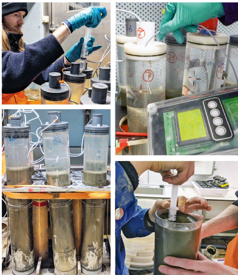
ABB. 5 Der Multicorer (MUC) ist ein Gerät, mit dem Proben vom Meeresboden genommen werden. Wenn der MUC auf dem Grund landet, werden seine Stechrohre langsam ins Sediment gedrückt. Beim Anheben werden sie automatisch zuerst oben und dann unten verschlossen. An Bord werden die Proben entnommen und direkt ins Labor gebracht. Fotos: Gritta Veit-Köhler (o. l., r.), AWI, SENCKENBERG, Universität Kiel (u. l.).
