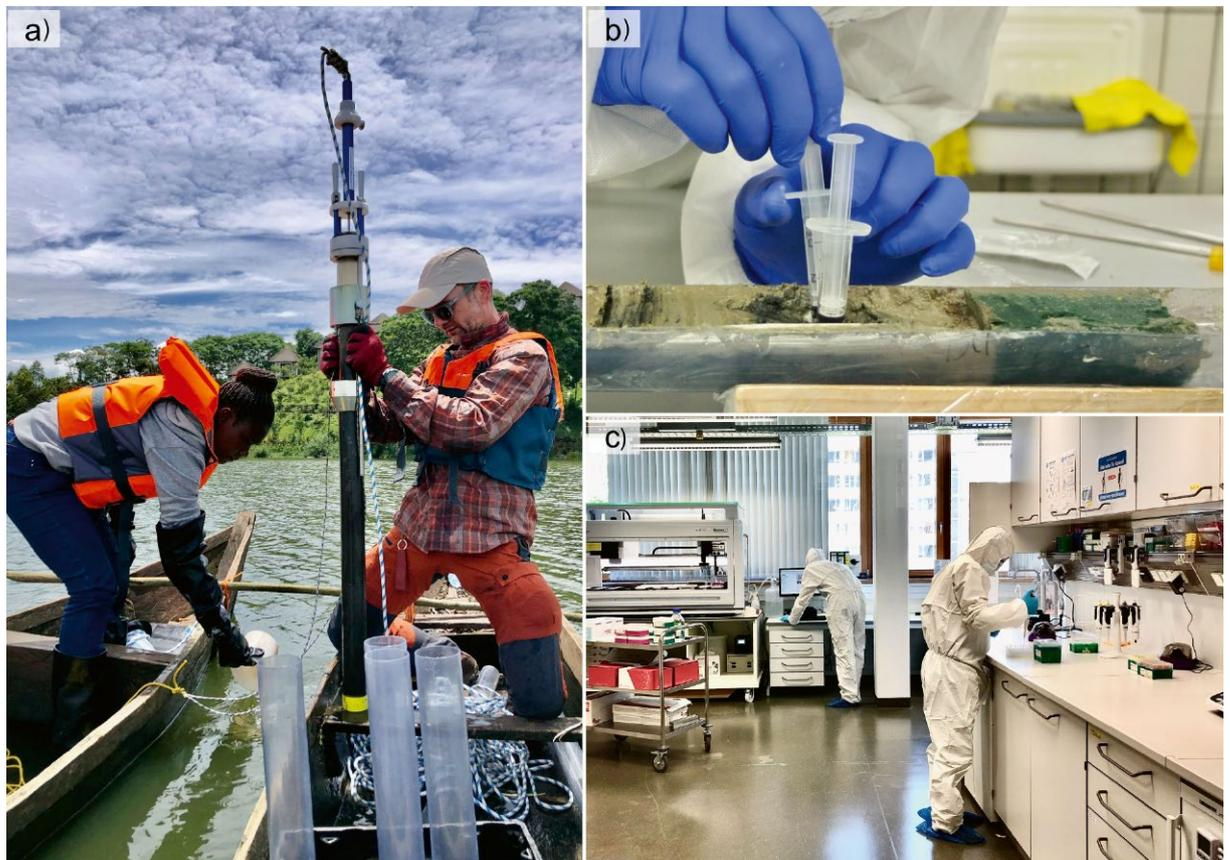
**ABB. 2** Verarbeitung von aeDNA aus Sedimenten. a) Sedimentkerne werden aus einem See entnommen, b) Entnahme von Proben aus einem Sedimentkern für die aeDNA-Extraktion unter geringen Kontaminationsbedingungen, c) Vorbereitung von *Metabarcoding*-PCR-Reaktionen mit Kontaminationskontrolle. Fotos: A. Junginger, L.S. Epp, M. Bálint.
